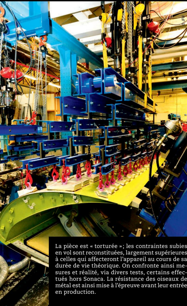
La pièce est « torturée » ; les contraintes subies en vol sont reconstituées, largement supérieures à celles qui affecteront l'appareil au cours de sa durée de vie théorique. On confronte ainsi mesures et réalité, via divers tests, certains effectués hors Sonaca. La résistance des oiseaux de métal est ainsi mise à l'épreuve avant leur entrée en production.
